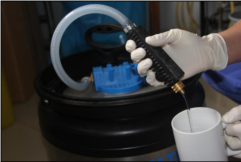
Waterwonder der Firma Evers, Deutschland, filtert Brunnenwasser zu Trinkwasserqualität
